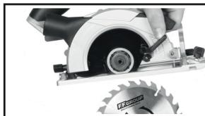
Utilice la llave de la cuchilla de sierra que está almacenada en la carcasa para cambiar la cuchilla de sierra.
